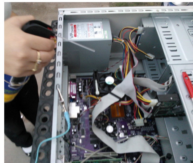
Limpiando un CPU con aire comprimido.
